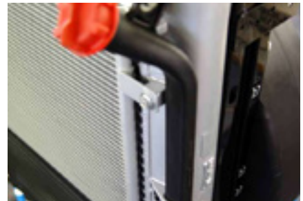
Wärmetauscher für LKW im Modulverbau aus Aluminium, CAB gelötet (Modine Europe GmbH, Filderstadt)
