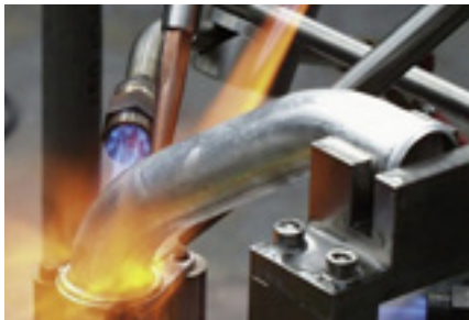
Flammlöten (Solvay Fluor GmbH, Hannover)
