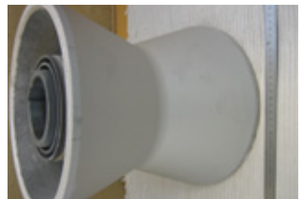
Hartgelötete Verschleißschutzschicht auf Transportrolle (Euromat GmbH, Baesweiler)
