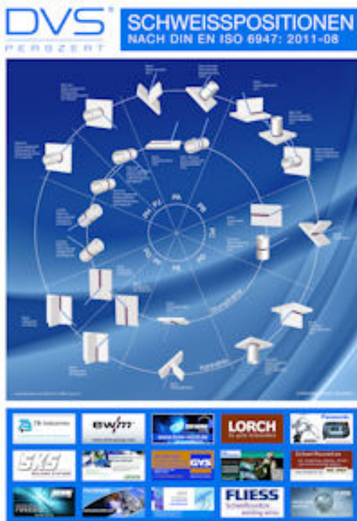
Das Poster „Schweißpositionen nach DIN EN ISO 6947“
