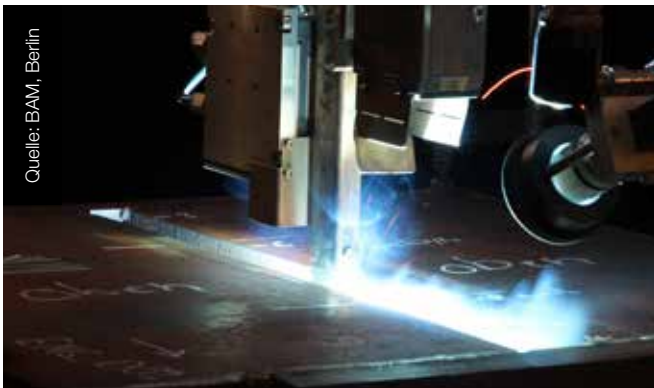
MSG-Engspaltschweißen am Demonstrator mit 50 mm Blechdicke
