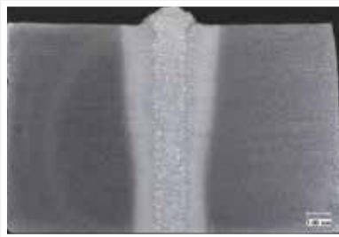
Laserstrahlschweißen unter Vakuum 10 mm Blechdicke – 6 kW – 8,5 mm/s
