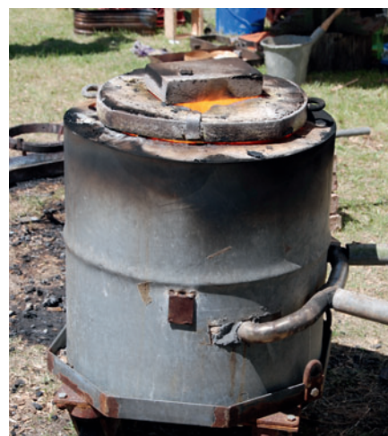
Ein selbst gebauter Rennfeuerofen zur Gewinnung von Eisen aus Eisenerz.
