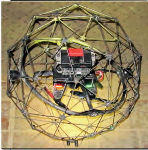
Inspektion/Besichtigung eines Dampfkessels durch den Einsatz einer Drohne
