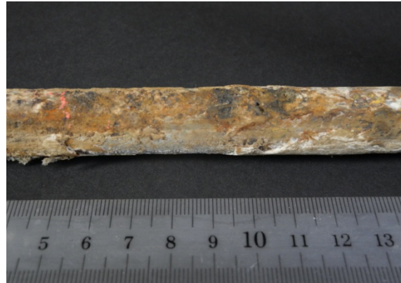
Bild 3: Korrosion auf der Rohraußenseite
