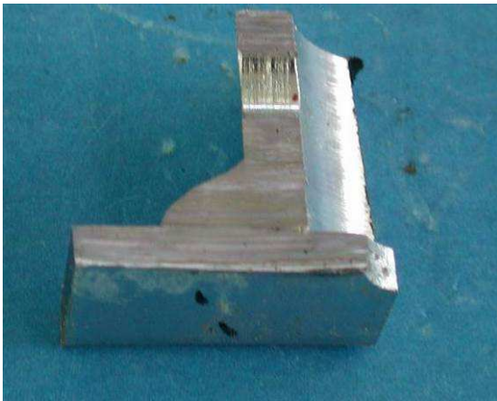
Schweißnaht mit Rissanzeigen
