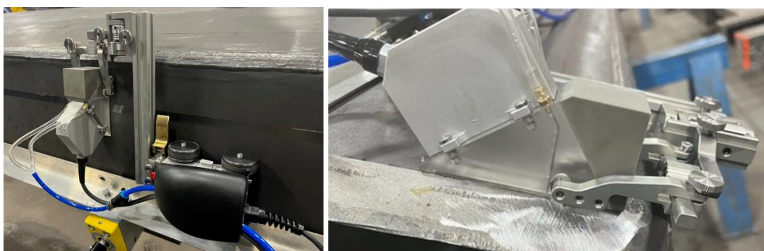
Bild 2. Phased Array-Prüfkopf und Manipulator mit Weggeber zur Schweißnahtprüfung
