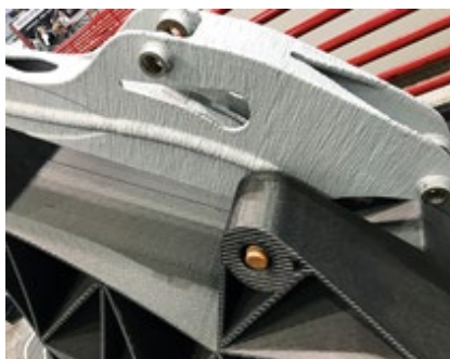
Prototyp von einem Gelenkausleger eines Baggers, gefertigt mittels WAAM-Verfahren (Wire Arc Additive Manufacturing-Verfahren).
