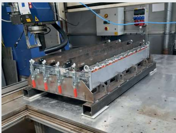
Laserstrahlschweißen in der Batteriefertigung (Bild: LMB Automation)
