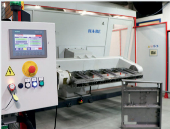
Gehäusebauer investiert in Roboteranlage zum automatisierten Schutzgasschweißen (Bild: Erl)
