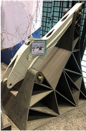
Das Foto zeigt einen additiv gefertigten Baggerarm. Bild: DVS
