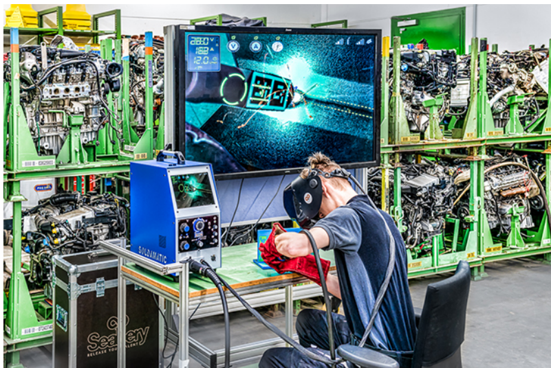
Schweißer im simulationsgestützten AR-Training mit SOLDAMATIC.
